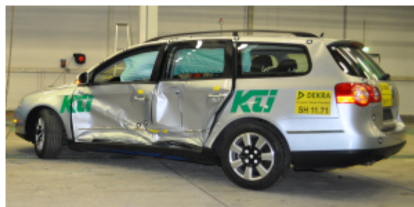
Bild 16: Schäden nach dem zweiten Crash
