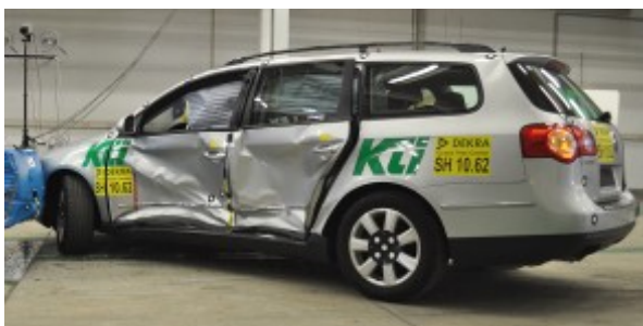
Bild 15: Schäden nach dem ersten Crash
