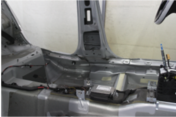
Bild 17: Seitenstruktur nach Erstcrash
