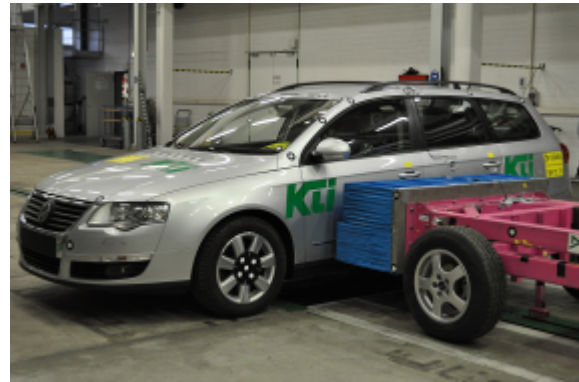
Bild 2: Positionierung des Stoßwagens
