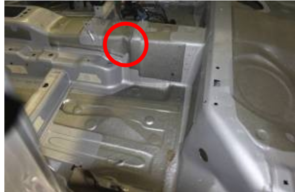
Bild 7: Knick im Mitteltunnel (rote Markierung)
