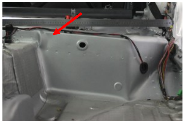
Bild 20: Konsole der Rücksitze nach Zweitcrash
